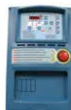
I quadri elettrici QAMPE servono al comando e controllo di gruppi elettrogeni in emergenza alla rete. Effettuano la sorveglianza della rete, del motore, del GE e della batteria al fine di garantire l'intervento. Sono previsti comandi manuali diretti, in caso di avaria elettronica. Anche durante il funzionamento manuale sono attive tutte le protezioni di motore e generatore. Sono predisposti per comando e controllo a distanza e dotati di potente e preciso caricabatteria.
